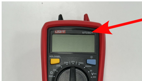
Mynd 5: Rauða örin sýnir númer fjölmælisins sem má nota til að ákvarða innra viðnámið samkvæmt töflunni.
